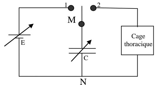
Le condensateur, réglé à la capacité de 1 millifarad, est chargé sous la tension de 1810 V.
