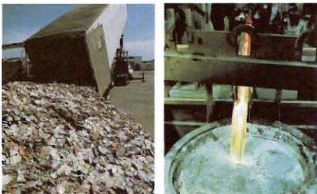
Fig. 59 Recyclage de l'aluminium
