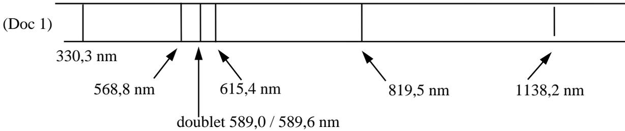
1-1) Identifier les longueurs d'onde des raies appartenant au domaine du visible, au domaine des ultraviolets et au domaine de l'infrarouge.
